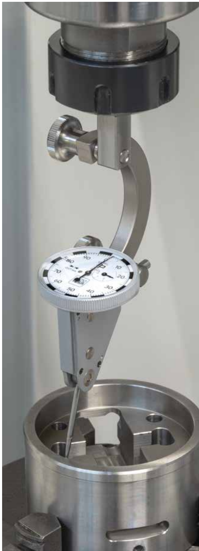
Použití centrovacího držáku páčkových úchylkoměrů poskytuje široký rozsah polohování měřidla, je především vhodné pro centrování obrobků v obráběcích strojích.
