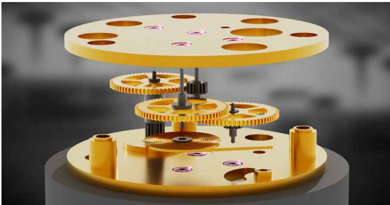
Koncepce uložení ústrojí mezi dvěma nezávislými disky přispívá ke spolehlivosti mechanismu.
