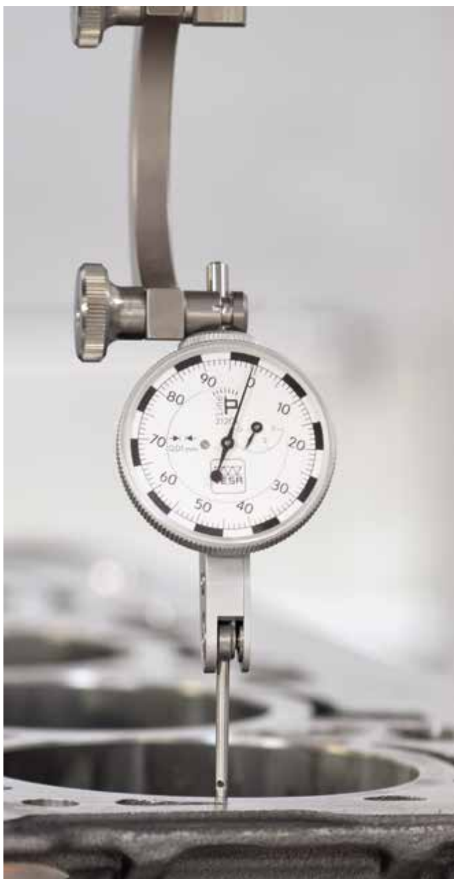
Použití centrovacího držáku páčkových úchylkoměrů poskytuje široký rozsah polohování měřidla, je především vhodné pro centrování obrobků v obráběcích strojích.
