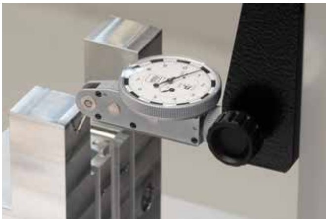
Měření kolmosti páčkovým úchylkoměrem P-LINE připevněným k výškoměru TESA MICRO-HITE.
