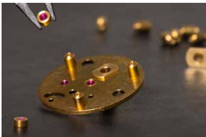
Dlouhou životnost mechanismu měřidla zajišťují rubínová ložiska.
