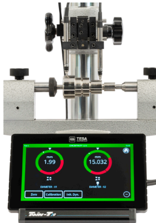
Měření dvou parametrů házivosti v jediné operaci.
