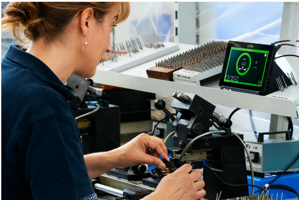
Měření souososti před montáží rotačních dílů.
