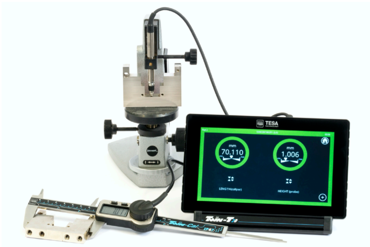
Měření dvou parametrů: jeden pomocí TESA indukční sondy, druhý pomocí posuvného měřítka připojeného k jednotce.
